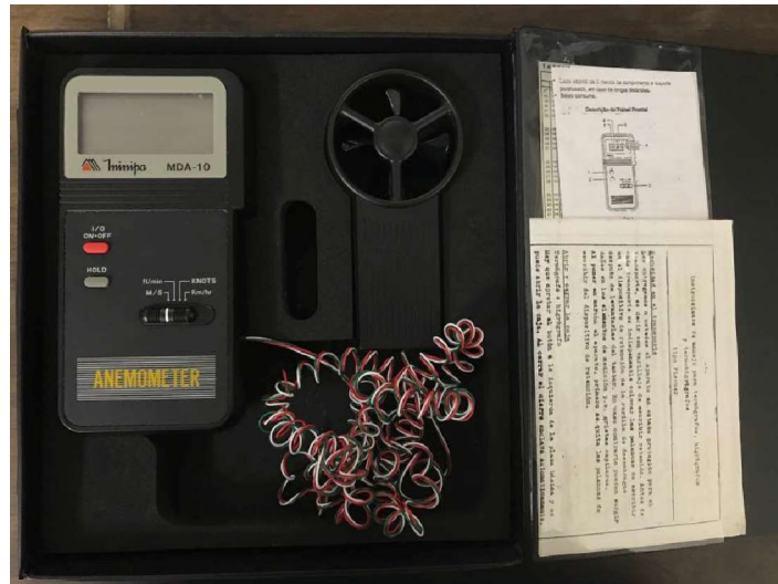
Figura11: Anemômetro cedido pelo Departamento de Meteorologia
